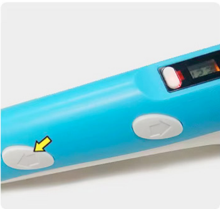
4. Po stisknutí tlačítka „zapnutí / ohřevu / dávkování“ dojde ke spuštění procesu nahřívání. Rozsvítí se červená kontrolka. Lze také ručně upravit nastavení hodnoty teploty dle vašich požadavků, či v závislosti na použitém materiálu vlákna. Provedete tlačítky po stranách displeje. (Toto není potřeba, jelikož ideální teplota je přednastavena v daném režimu.)
