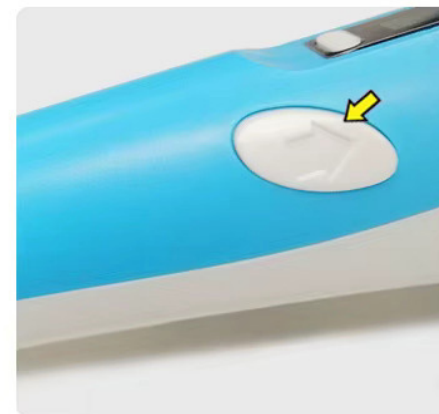
8. Po použití krátce stiskněte tlačítko „vysunutí vlákna / vypnutí“, vlákno bude vysunuto z pera. Dlouhým stiskem tohoto tlačítka pero vypnete. Pokud nebude ve stavu vypnutí používáno, dojde po 5 min. automaticky ke spuštění procesu vysunutí vlákna (ikdyž není vloženo) a následně se pero vypne do pohotovostního stavu. Zůstane svítit žlutá kontrolka.
