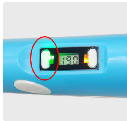
5. Po dosažení přednastavené teploty dle příslušného režimu dojde k vypnutí ohřevu. Svítí kontrolka se změní z červené na zelenou. V tomto kroku lze také ještě ručně jemně upravit hodnotu teploty tlačítky po stranách displeje.
