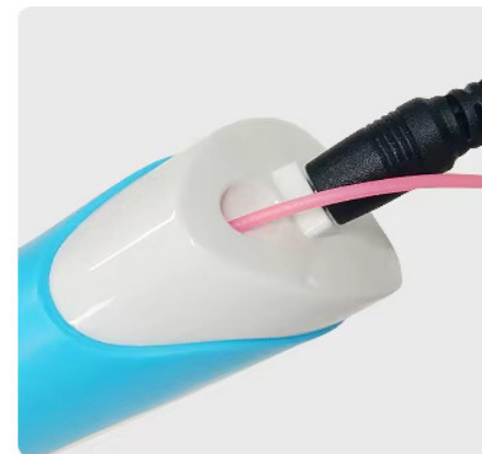
6. Zatlačte ABS/PLA vlákno do vstupního otvoru na konci pera a stlačte krátce tlačítko „zapnutí / ohřevu / dávkování“ pro výstup náplně z hrotu pera. Proces dávkování přerušíte krátkým stiskem tlačítka „zap. / ohřevu / dávkování“.
