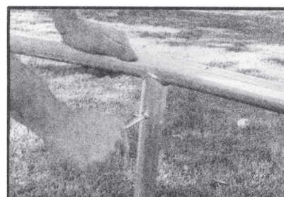
5. K hlavnímu rámu přišroubujte nejdříve zkompletované nohy.
